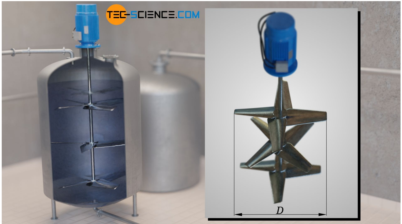
Figura: Determinazione del numero di Reynolds di un flusso in un recipiente agitato
